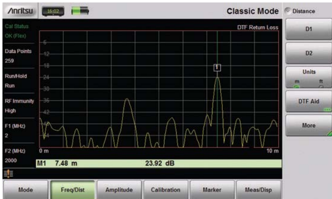
Экран измерения расстояния до повреждения
